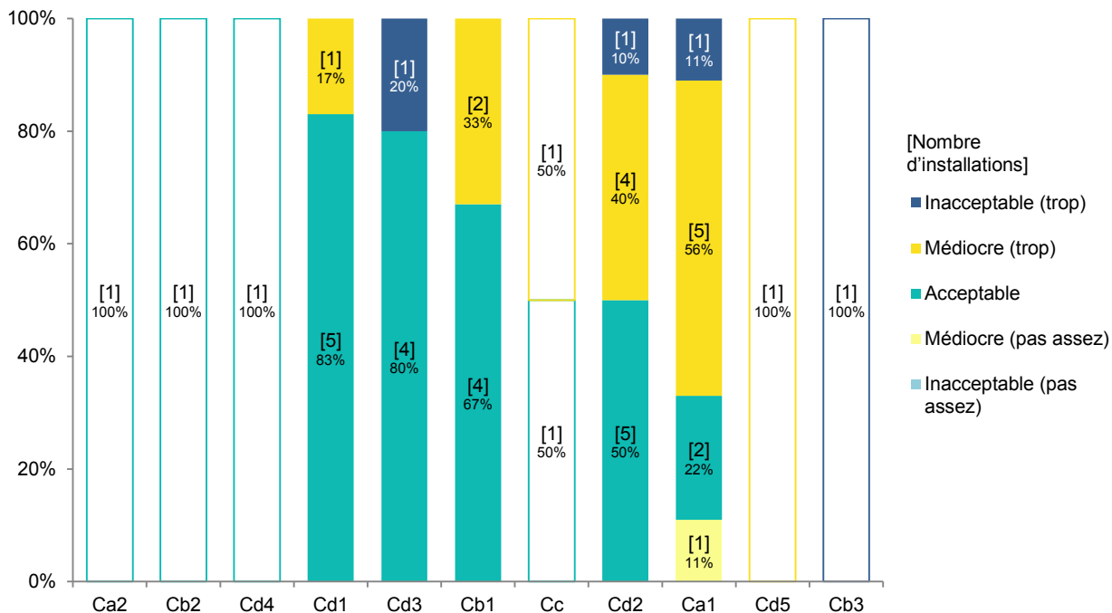
Figure 59 : Répartition des installations des CL par dispositif selon leurs fréquences de vidange « acceptable », « médiocre » (trop ou pas assez) ou « inacceptable » (trop ou pas assez)
